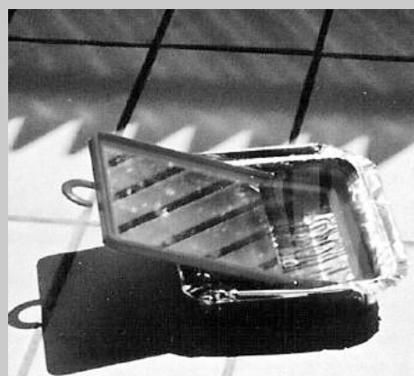
Dispositif orienté par rapport au soleil pour obtenir une décomposition de la lumière blanche
